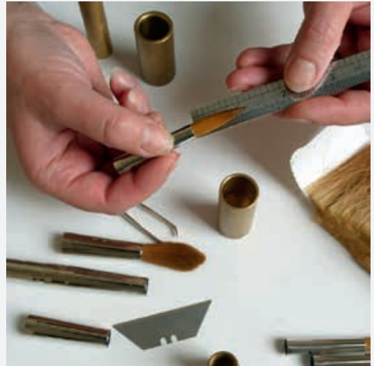
4 การตรวจครั้งสุดท้าย และการวัดความยาวว่าถูกต้องหรือไม่
